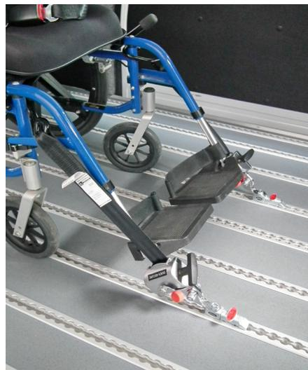
Die selbstspannenden Retraktoren mit zusätzlichem Handspanner erlauben die sichere Verzurrung des Rollstuhls nach allen Seiten.
