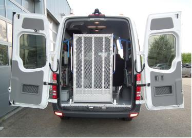
Die 2-teilige, ultraleichte Rampe aus Aluminium-Streckmaterial mit Stützplanken wird ganz einfach an den langen seitlichen **Haltegriffen** ausgeklappt. Eine **Gaszugfeder** hebt einen Teil des Rampengewichtes auf und **erleichtert das Einklappen** erheblich. Die gefaltete Rampe wird in der Halterung im Heck des Fahrzeugs eingerastet und mit dem Sicherheitsgurt im oberen Bereich befestigt. Die Oberfläche bleibt auch bei nasser Witterung **rutschfest**.
