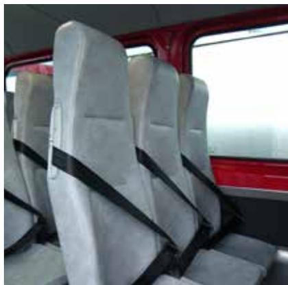
**Der seitliche Gurtauslass über 170 mm Höhe garantiert eine richtige Gurtführung bei kleinen und grossen Passagieren.**
